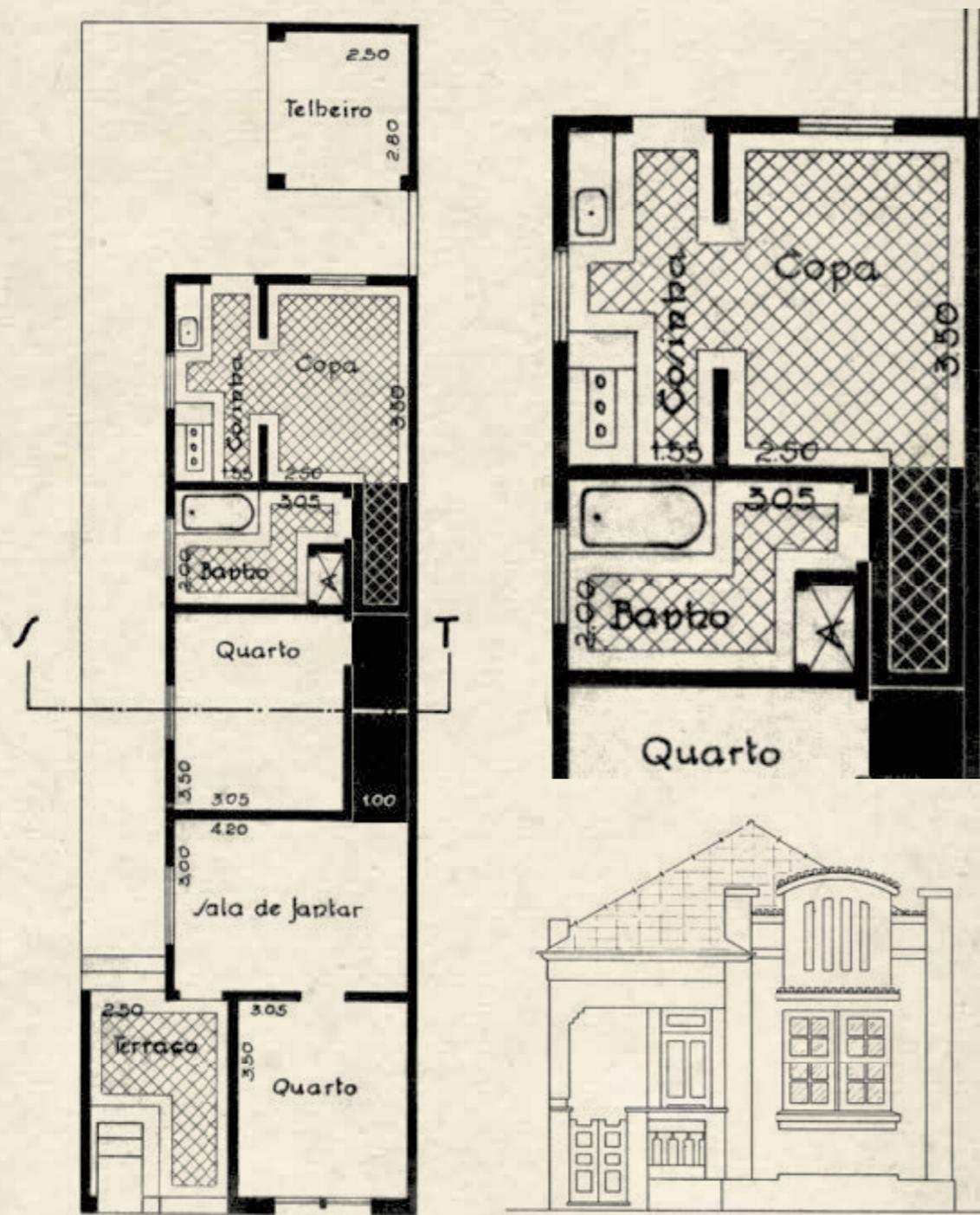
FIG.24: Planta arquitetônica e detalhe. No setor de serviços da moradia, a cozinha de dimensão reduzida (5,42m<sup>2</sup>, sendo 1,55m X 3,50m) era o local destinado ao preparo dos alimentos, e a copa, de maior área (8,75m<sup>2</sup>, sendo 2,50m X 3,50m) era utilizada para a tomada das refeições. Notar que a cozinha estava próxima ao banheiro interno, compondo o "par-hidráulico". PC 72/48. (APH-RC)
