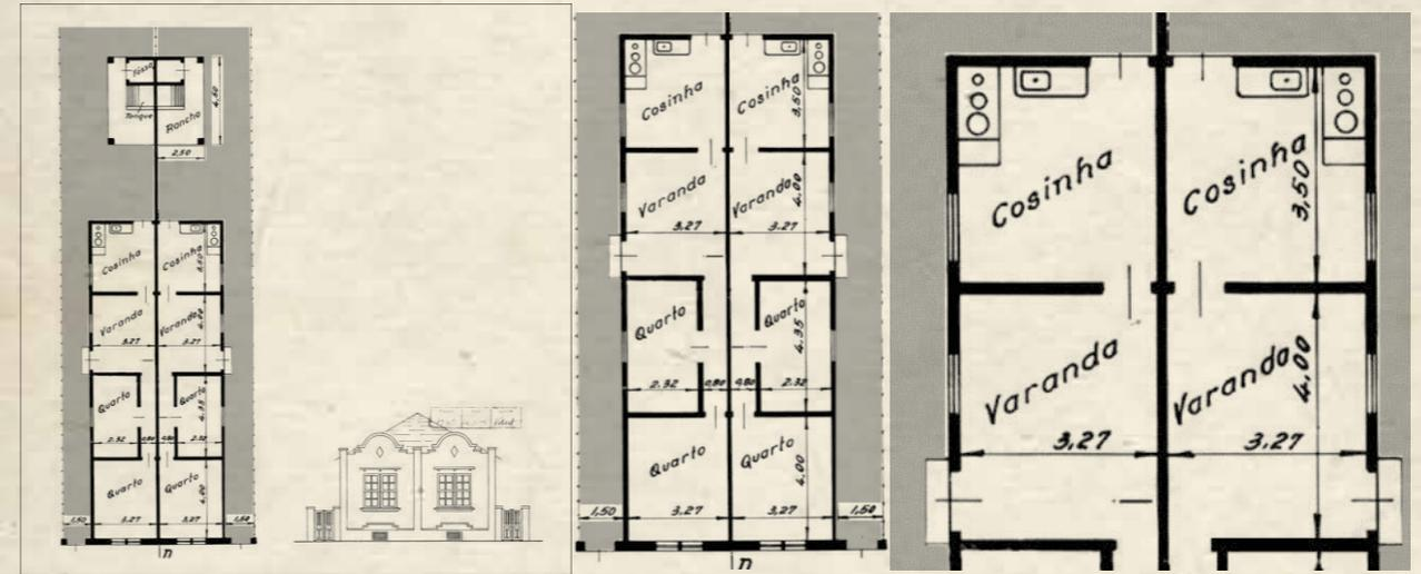
FIG.22: Planta arquitetônica e detalhe. Duas moradias, geminadas, com cozinha de 11,45m<sup>2</sup> (3,27m X 3,50m) na parte posterior da planta principal, próxima ao quintal. PC 108/48. (APH-RC)
