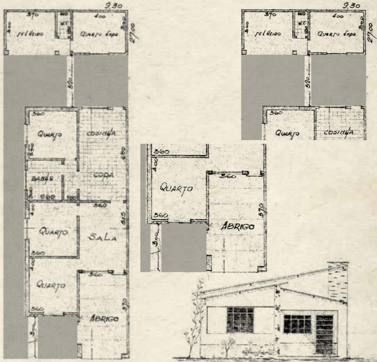
FIG.30: Planta arquitetônica e detalhe. No setor de serviços, na parte posterior da planta de 1960, a lavanderia estava localizada em construção anexa, que ainda apresentava dois cômodos designados como quarto e W.C., possivelmente utilizados para moradia do empregado doméstico ou para despejos. PC 17/60. (APH-RC)
