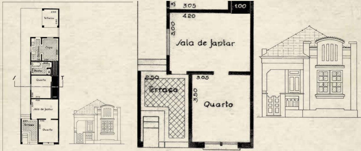
FIG.15: Planta arquitetônica e detalhe. Acesso lateral ao interior do domicílio, pelo terraço frontal, que configurava cômodo de 8,75m<sup>2</sup> (2,50m X 3,50m), superior à média encontrada nas residências rio-clarenses. Notar na composição da fachada que o peitoril, que divide o acesso frontal com o portão de madeira, era geralmente fechado por balaústres. PC 72/48. (APH-RC)
