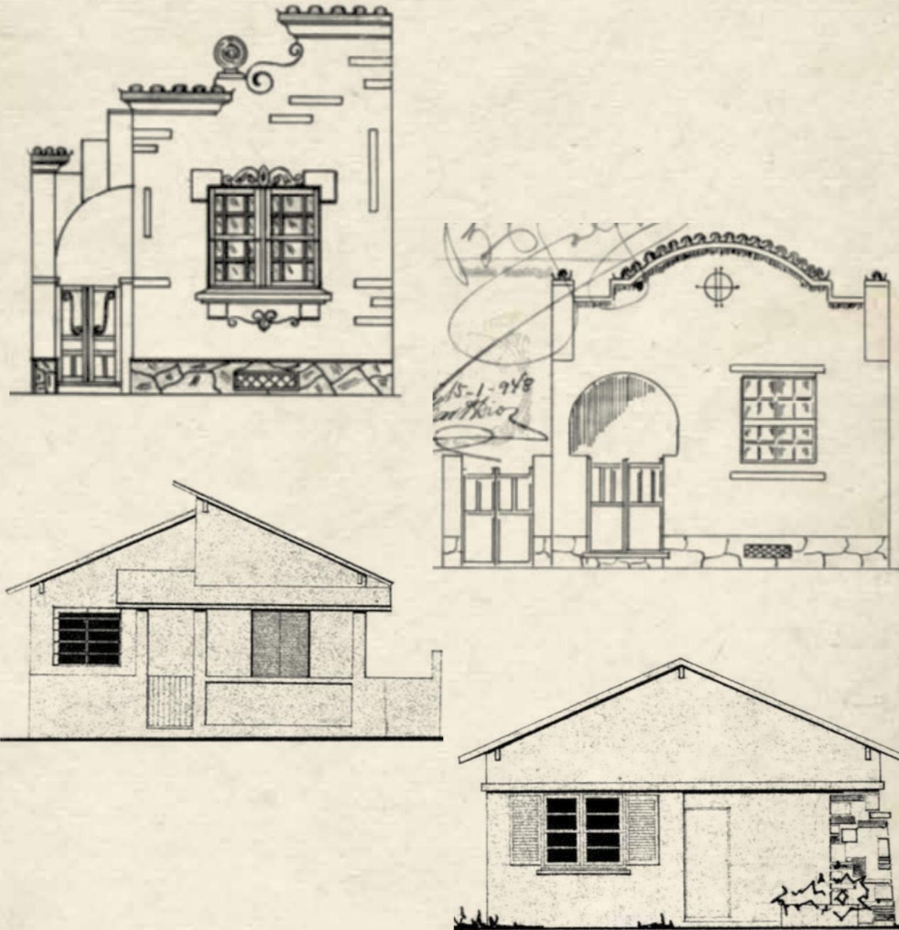
FIG.41: Desenho da fachada. Observar a existência do porão nas moradias do ano de 1948, presença denunciada pela abertura sob a janela frontal, fechada por gradil de ferro (que permitia a entrada e a constante renovação do ar) e a sua ausência na construção de 1952 que, possivelmente, utilizou material para impermeabilização do solo e dos alicerces. PC 12/48, PC 13/48, PC 461/60 e PC 66/60. (APH-RC)
